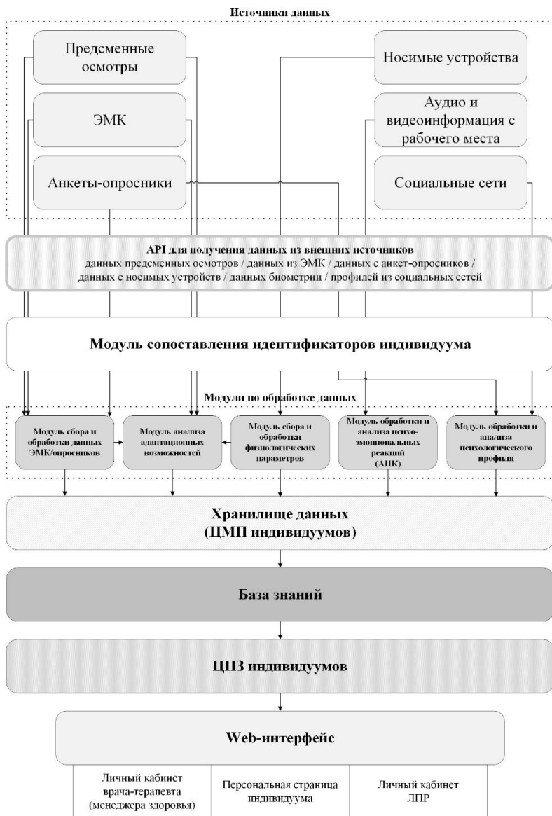
Рис. 1. Структурная схема информационных потоков системы мониторинга здоровья и психоэмоционального состояния операторов
