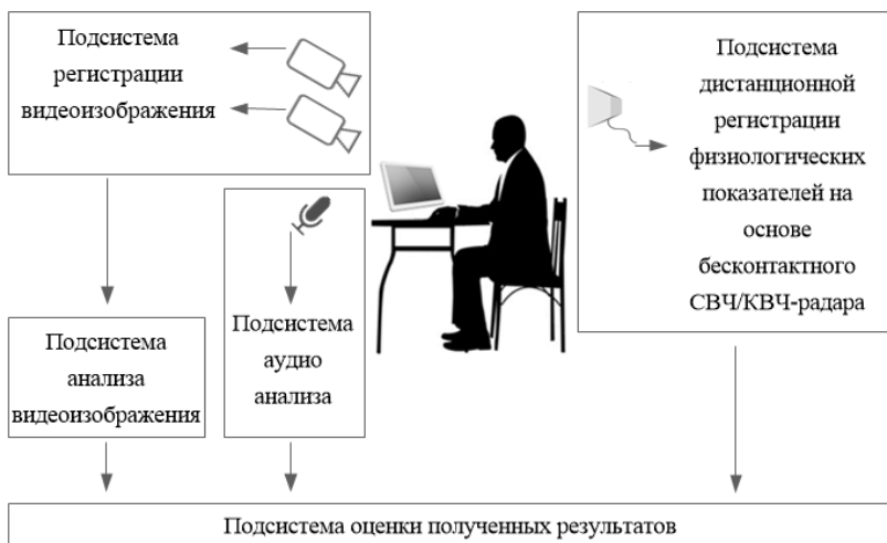
Рис. 3. Схематическое изображение подсистем, входящих в состав АСДА
